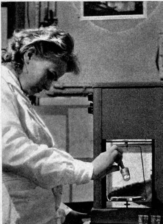
Pesée finale au centième de milligramme du perchlorate de potassium sur la balance Mettler.
